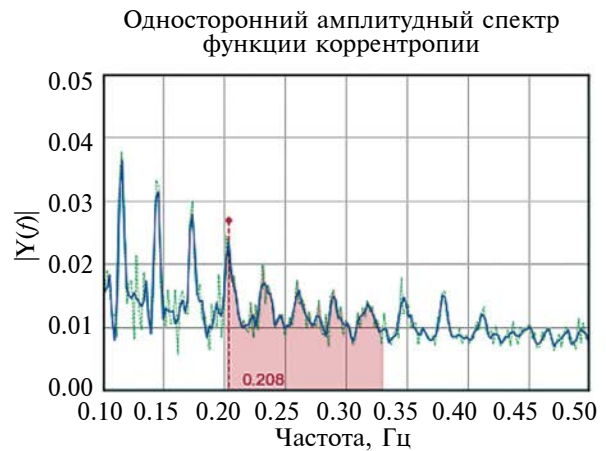
Рис. 5. Графики спектров функции коррентропии двух пульсовых волн (слева спектр для 1-й волны, справа – для 2-й) с отмеченным значением измеренной частоты дыхания (синим цветом показана кривая сглаженных значений, красным цветом закрашен диапазон частот дыхания D ).
